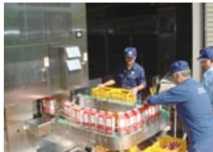
充填機によるカートン品質の検証(リキッドパッケージングセンター)
