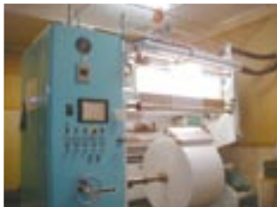
ポリエチレン袋製造工程で異物混入を防止する欠点検出機
