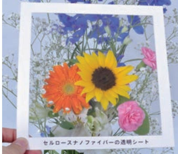
セルロースナノファイバーから作製した透明シートの概観
