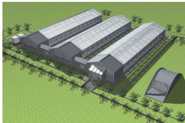
小松島工場内に建設中の閉鎖型大型温室の完成予想図
