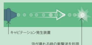
ミネラルを高配合できたきっかけは当社独自の「キャビテーション噴流によるパルプ処理技術」の応用です。高速噴流にて発生した泡が壊れる時の力を利用します。
