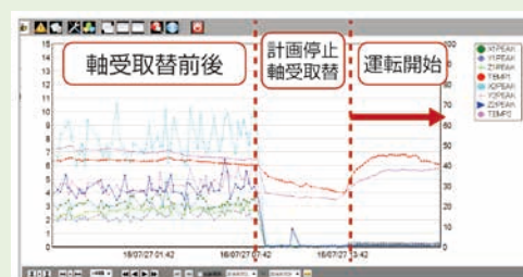
e-無線巡回®による監視モニター例
