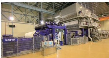
サイアム・ニッポン・インダストリアルペーパー社 片艶マシンのドライヤーパート
