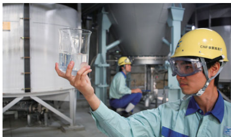
セルロースナノファイバー分散液と実証生産設備
