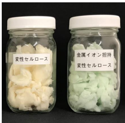
(左) 変性セルロース単体と金属イオンを担持させた変性セルロース (右) 金属イオン担持変性セルロースを不織布に加工したサンプル
