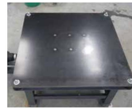
写真-3: 加振変形試験機
