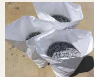
FLASH BAGに20mm骨材を充填し、3段重ねにした状態に散水した状態です。散水後、数秒足らずで袋のパルプ繊維は解け、充填物の骨材が紙を押し破るようにして現れます。
