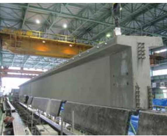
写真-1: CfFAプレキャストPC桁の製作状況
