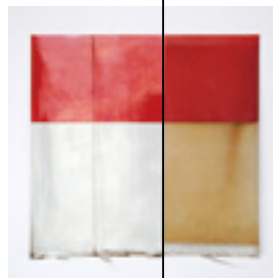
設置:45° 屋外3年 左側:施工済 / 右側:未施工 ※清掃はしてありません。
