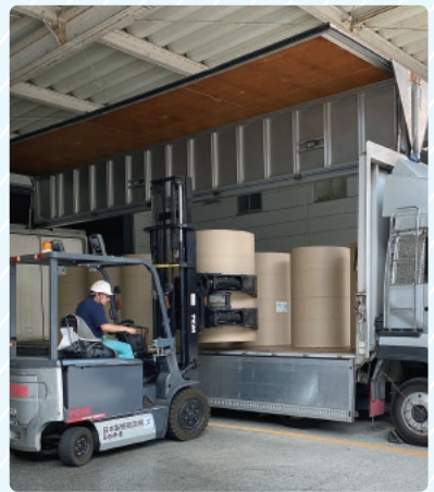
クランプによる荷下ろし作業
