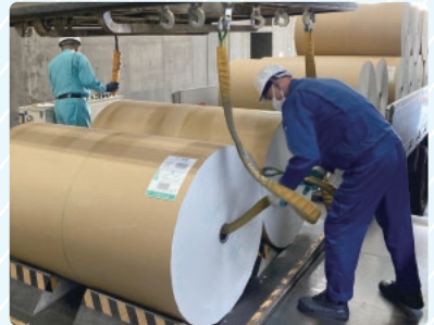
ホイストクレーン玉掛け作業
