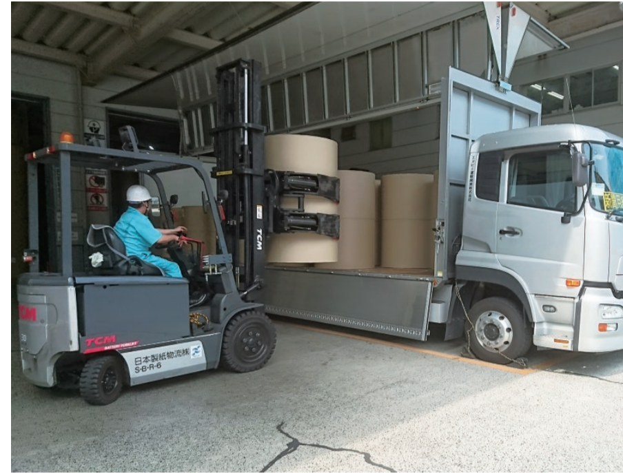
ウイング車からの荷卸作業
