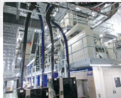
三菱重工機械システム(株)製 4×1輪転機「DIAMOND SPIRIT」
