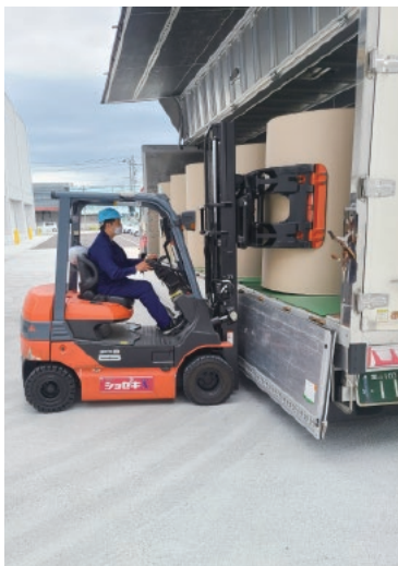
フォークリフトによる巻取り搬入
