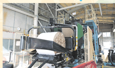
ロール状に圧縮し出荷用にパックする製造ライン
